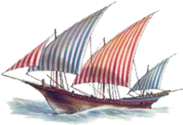
*Jabeque es una embarcación de casco fino, estrecho, borda baja, alargado de poco calado con aparejo de 3 velas inclinadas.*
